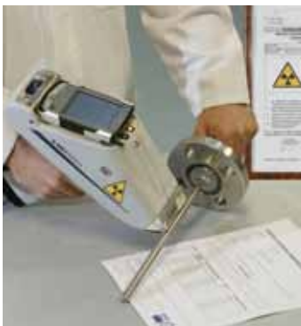
Identificación positiva del material (PMI) y control de la calidad por análisis visual
