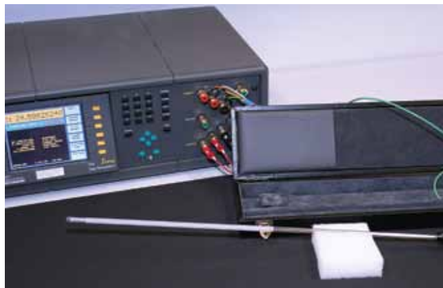
Termómetro ITS90 calibrado, termómetro de referencia SPRT (Standard Platinum Resistance Thermometer)
