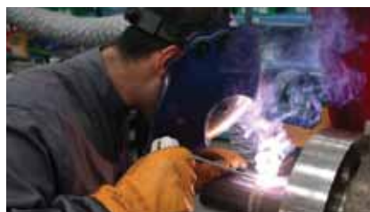
Soldadura con arco eléctrico cualificada
