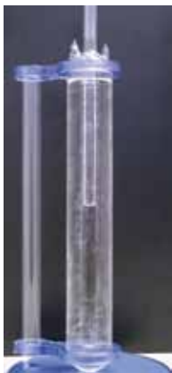
Celda para calibración en punto triple del agua
