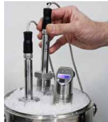
Calibración del punto cero en baño de hielo
