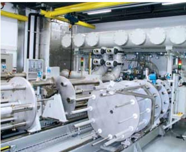
Un grupo de tres medidores de referencia trazables y calibrados periódicamente (boquillas, pistón giratorio y turbinas) garantiza la calibración de los caudalímetros de los clientes dentro de una incertidumbre de medición del  $\pm 0,3\%$ . Un sistema de control especial de la climatización mantiene el aire dentro de la cámara de calibración a una temperatura constante de 24 °C y una humedad del 40% durante el día y la noche.
