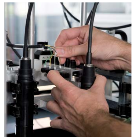
El procedimiento de 4 haces de luz pulsado compensa los efectos de la suciedad, así como los causados por el envejecimiento.
