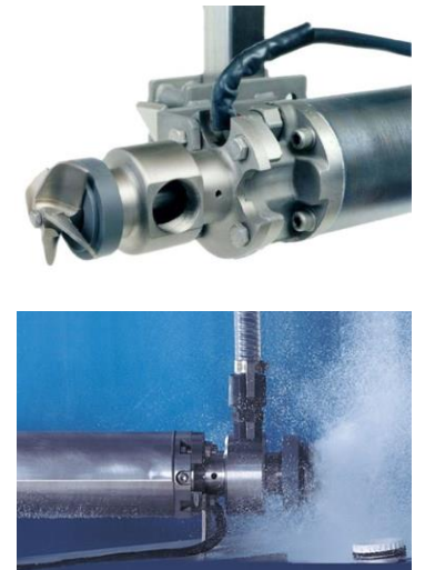
Dosificación Cloro Gas y Químicos Líquidos por Inducción - Waterchamp (Gases hasta 3000 PPD Líquidos hasta 25 GPM)
